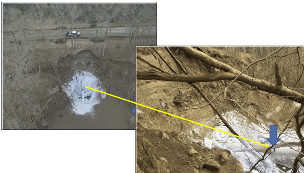
Figur 10: Dannelse af tør is efter udslip af CO 2
